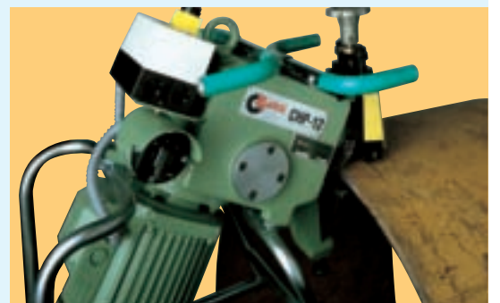
Vista de la máquina realizando la operación de chaflanado en tubos de distinto tamaño. View of the machine beveling tubes of different sizes. Vue de la machine en train de réaliser l'opération de chanfreinage sur des tubes de taille différente.
